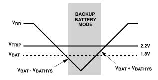
FIGURE 9. BATTERY SWITCHOVER WHEN  $V_{BAT} < V_{TRIP}$
