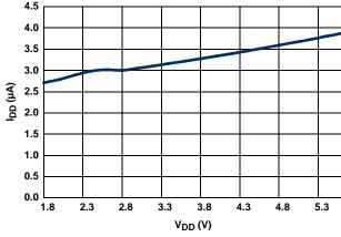
FIGURE 5.  $I_{DD3}$  vs  $V_{DD}$
