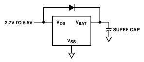
FIGURE 24. SUPER CAPACITOR CHARGING CIRCUIT
