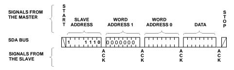
FIGURE 16. BYTE WRITE SEQUENCE
