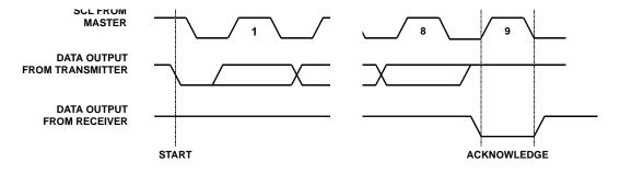
FIGURE 14. ACKNOWLEDGE RESPONSE FROM RECEIVER
